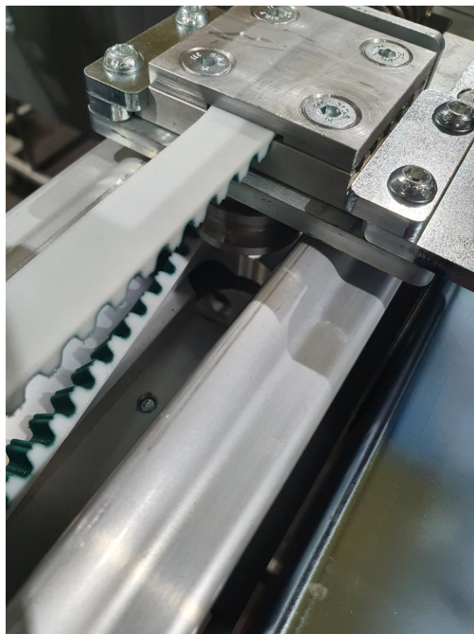
Den unteren Zahnriemen zur Seite drehen Turn the lower timing belt to the side
