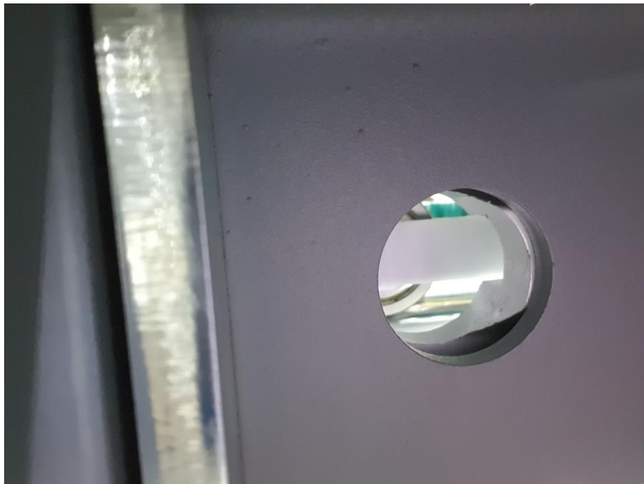
Unter der Führung ist ein Loch. Durch dieses sieht man den Zahnriemen. There's a hole under the guide. Through this you can see the timing belt.
